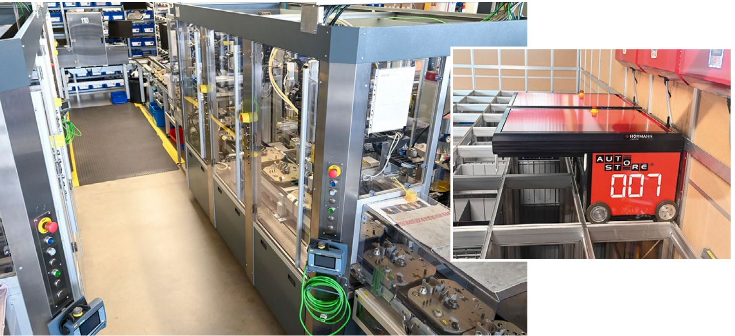
Automatische Baugruppenmontage bei Novopress und selbstfahrende Roboter im AutoStore-Lager.
